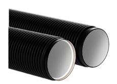
Трубы **КОРСИС ПЛЮС** рекомендованы для строительства магистральных сетей хозяйственно-бытового, промышленного и ливневого водоотведения, ремонта водопропускных труб под дорогами. Соответствуют требованиям **ГОСТ Р 54475-2011**. Трубы **КОРСИС ПЛЮС** соединяются сваркой при помощи раструба с интегрированным электронагревателем.
